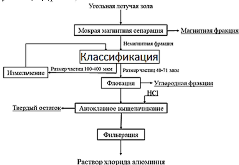
Рис. 2. Блок-схема процесса извлечения глинозема из золы ТЭС
